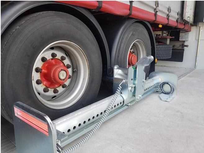
**EASYBLOCK es el único sistema manual que no permite al chófer retirar el cilindro de bloqueo durante la operación de carga/descarga por la acción del electroimán que solo se puede desbloquear cuando detecta que la puerta del muelle está cerrada**
